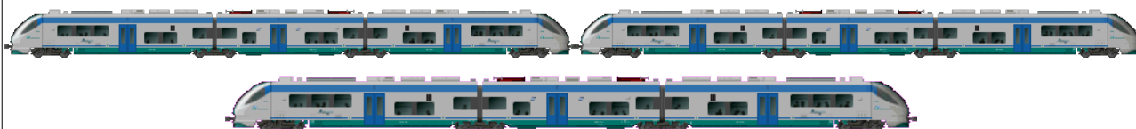
TTR / Minuetto - 3 elementi trazione elettrica (ALe501+Le220+ALe502)
